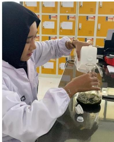
**Gambar 3.6** Proses Penambahan Pelarut Etanol 96%
