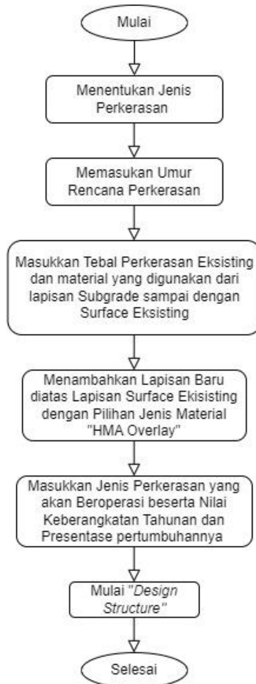
Gambar 3.9 Urutan Pengerjaan Perhitungan Overlay dengan Software FAARFIELD
