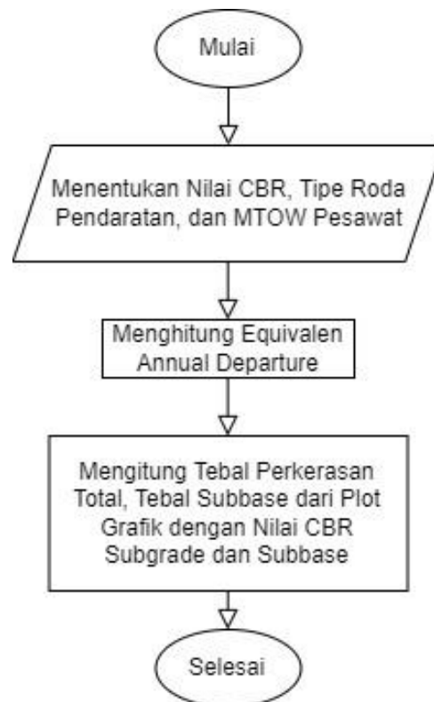
Gambar 3.8 Urutan Pengerjaan Perhitungan Perkerasan menggunakan Cara Manual
