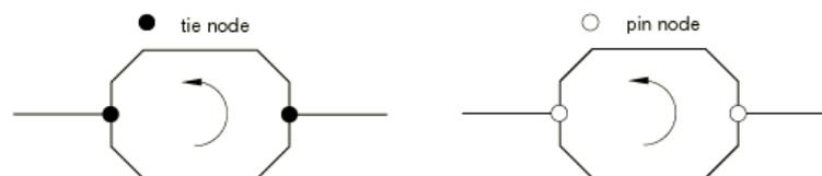
Gambar 2.24 *Rigid Body* dengan *Tie Node* dan *Pin Node Connections*
