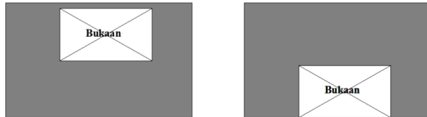
Gambar 3. 15 Ketidakberaturan Diskontinuitas Diafragma Sumber: (Badan Standardisasi Nasional 2019b)
