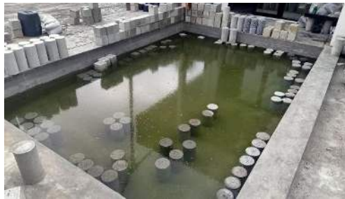
Gambar 3.22 Perawatan basah benda uji
