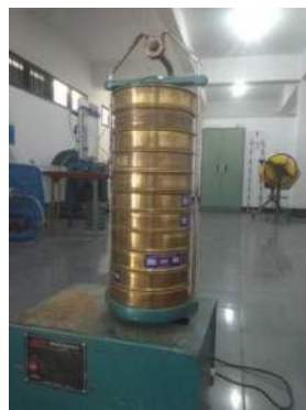
Gambar 3.5 Mesin penggetar ayakan
