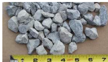
Gambar 2.4 Skematis susunan butir agregat berbentuk tak beraturan
