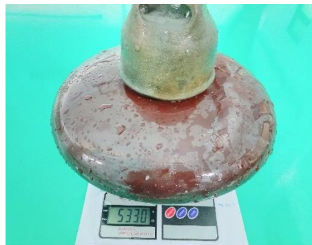
Gambar 3. 25 Massa Isolator Porselen Jenis Piring Keadaan Basah
