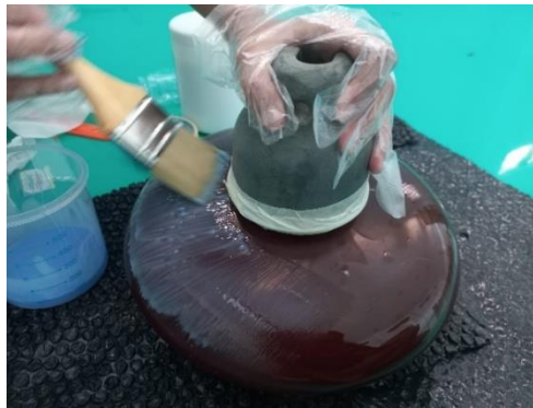
Gambar 3. 21 Pelapisan RTV SiR Pada Permukaan Isolator
