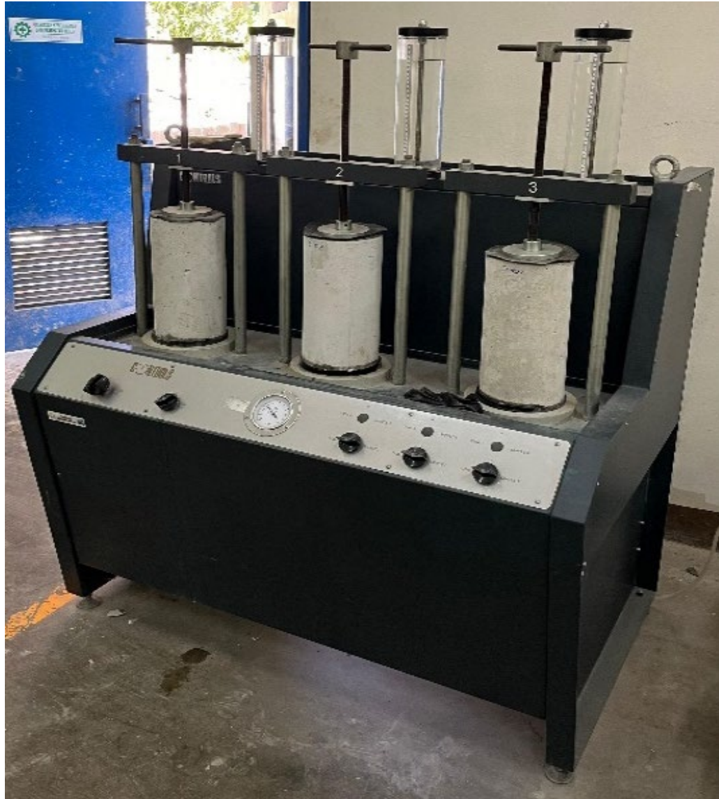
Gambar 3.2 Set-up pengujian permeabilitas beton
