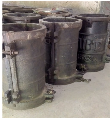
Gambar 3.6j Cetakan Silinder Beton
