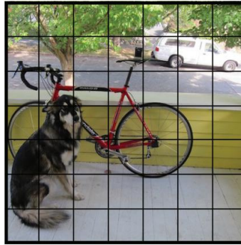
Gambar 2.4 Gambar input yang dibagi ke dalam kisi-kisi (Redmon dkk., 2016)
