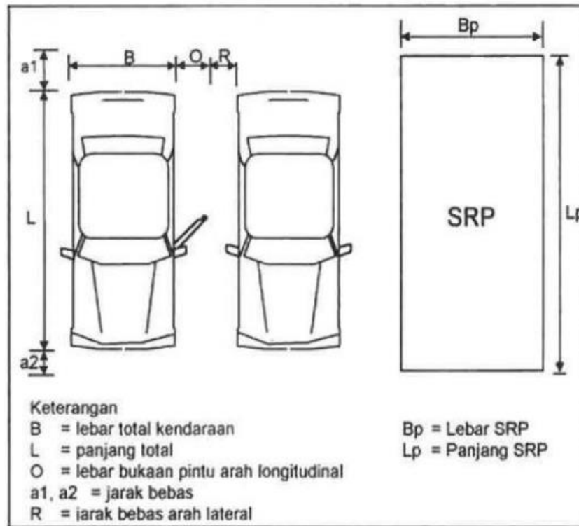
Gambar 2.2 Satuan Ruang Parkir untuk Mobil Penumpang (dalam cm)
