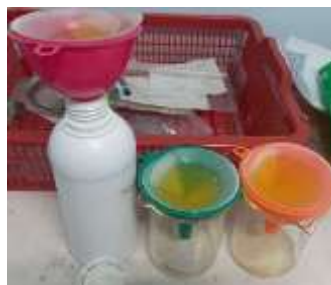
Gambar 3. 5 Proses Filtrasi Residu Kaolin dan Minyak Trafo
