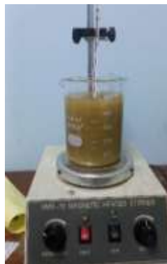
Gambar 3. 4 Proses pengadukan campuran kaolin dan minyak transformator menggunakan magnetic stirrer .
