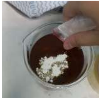
Gambar 3. 3 Pencampuran kaolin hasil aktivasi ke dalam minyak transformator bekas.
