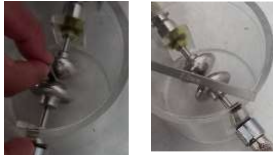
Gambar 3. 11 Pengaturan jarak sela bola setengah elektroda
