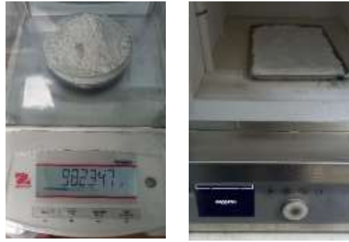
Gambar 3. 2 Proses Pengukuran Massa Kaolin dan Aktivasi Kaolin
