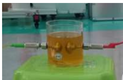
Gambar 3. 12 Sampel Minyak Trafo yang berada dalam Kotak Uji
