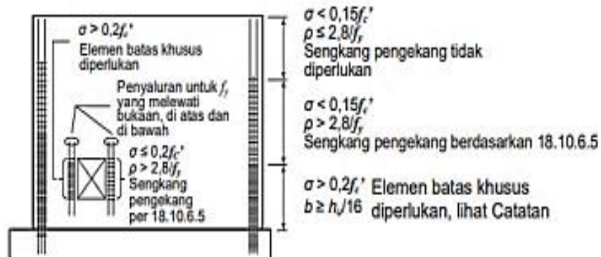
Gambar 2.11 Dinding yang Didesain dengan Pendekatan Berbasis tegangan
