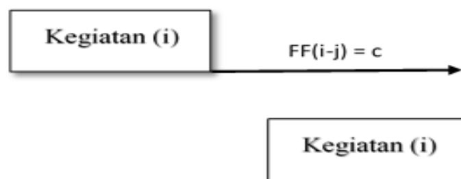
Gambar 2.4 Bentuk Konstrain Finish to Finish
