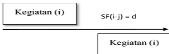
Gambar 2.5 Bentuk Konstrain Start to Finish
