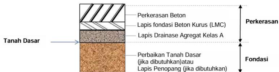
Gambar 2.2 Komponen Perkerasan Kaku ( Rigid Pavement )
