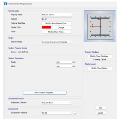
Gambar 3. 22 Define Frame Section kolom komposit
