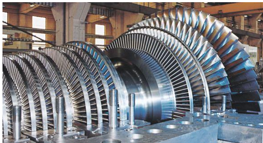
Gambar 2.3 Turbin UAP PLTU
