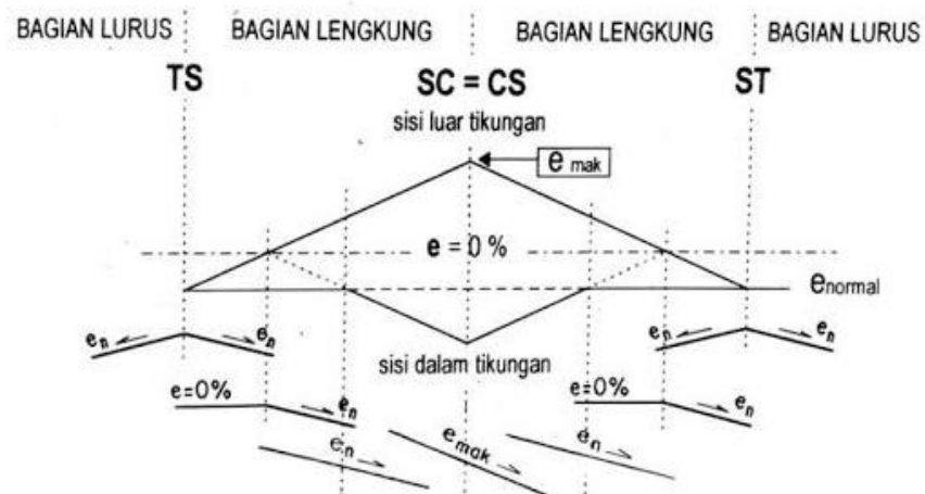
Gambar 2 23 Pencapaian Superelevasi pada Tikungan Tipe SS
