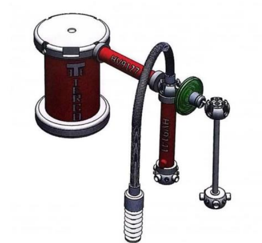
Gambar 3. 4 Rangkaian Tegangan Uji Flashover
