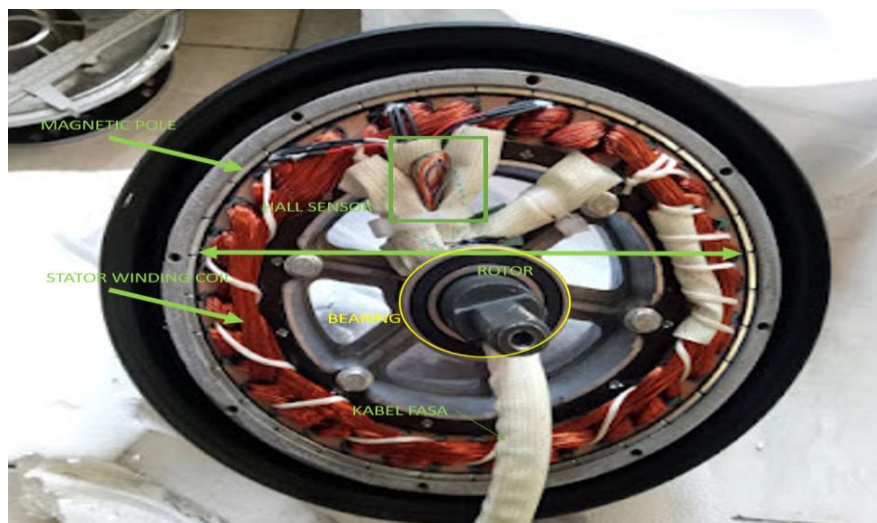
Gambar 2. 6 Struktur Komponen Motor BLDC
