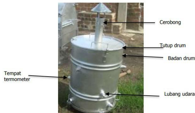
Gambar 2. Pirolisator terbuat dari drum
