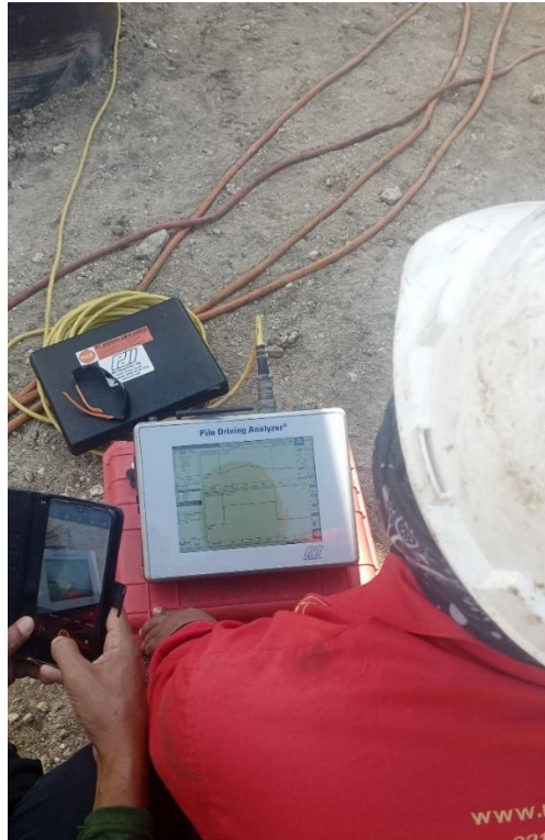
Gambar 4.2 Uji PDA Tiang Pancang SP2 pada Abutment A1.
