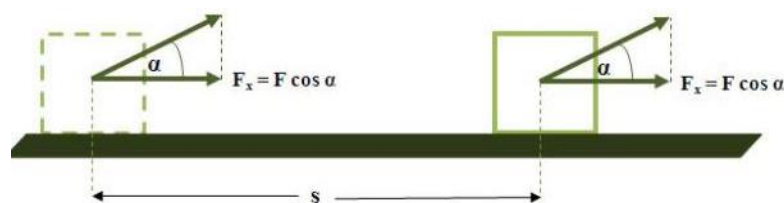
Gambar 2.3 Gaya yang Bekerja Membentuk Sudut Sesuai Arah Perpindahan. Sumber: (Diary, 2011)
