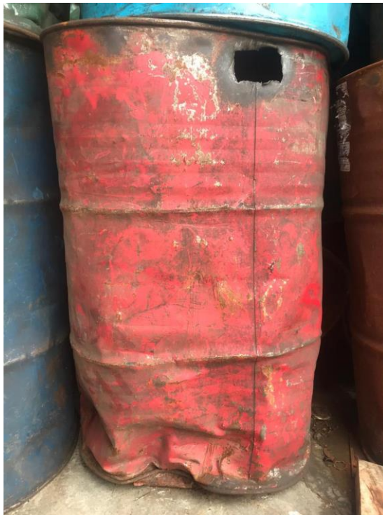
Gambar 2. 7 Jenis Drum Yang Tidak Layak Direkondisi
