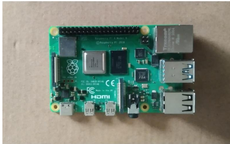
Gambar 2. 1 Gambar tampak atas Rasberry Pi 4 Model B
