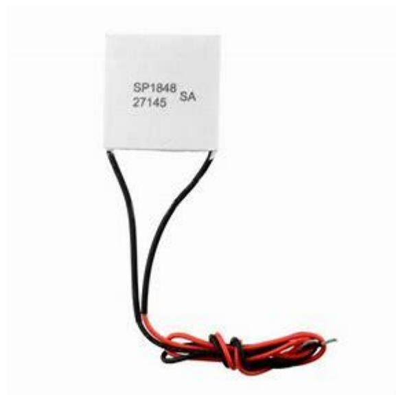
Gambar 3.4 Modul thermoelectrtic TEG SP1848-27145 SA
