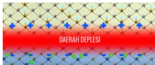
Gambar 2. 1 Prinsip Kerja Sel Surya
