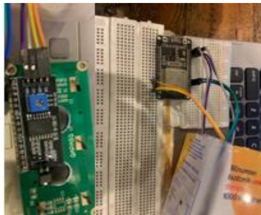
Gambar 3.12 Menunjukkan hubungan antara LCD dan ESP32
