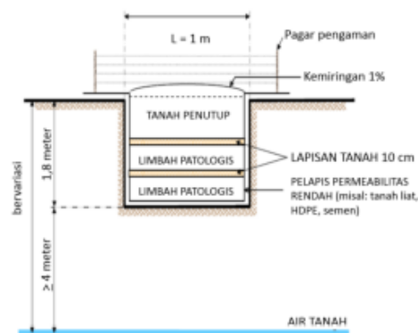
Gambar 2.16 Sketsa Fasilitas Penguburan Limbah Patologi dengan Dimensi Ukuran 1,8m x 1m x 1m (Kementerian LHK RI, 2015)
