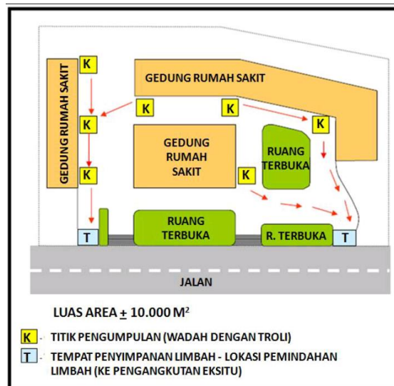
Gambar 2.17 Contoh Tata Letak Rute Sistem Pengumpulan Limbah dari Kegiatan Fasyankes (Kementerian LHK RI, 2015)
