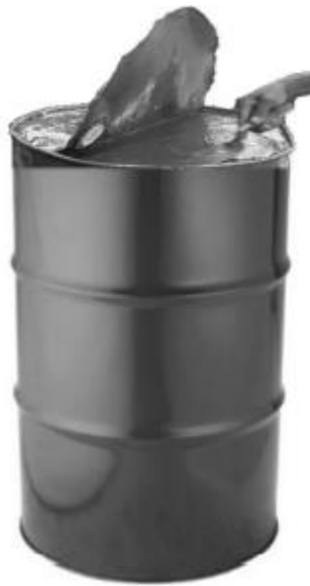
Gambar 2.14 Contoh Enkapsulasi Limbah B3 dengan Semen (Kementerian LHK RI, 2015)
