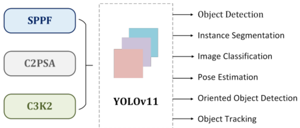
Gambar 2.7.3 Blok Penting dari YOLOv11 dan Fungsinya
