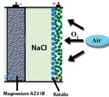
Gambar 3. 2 Ilustrasi struktur 1 sel baterai magnesium Udara (telah diolah kembali)
