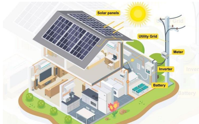
Gambar 2. 9 Prinsip kerja Instalasi PLTS Hybrid
