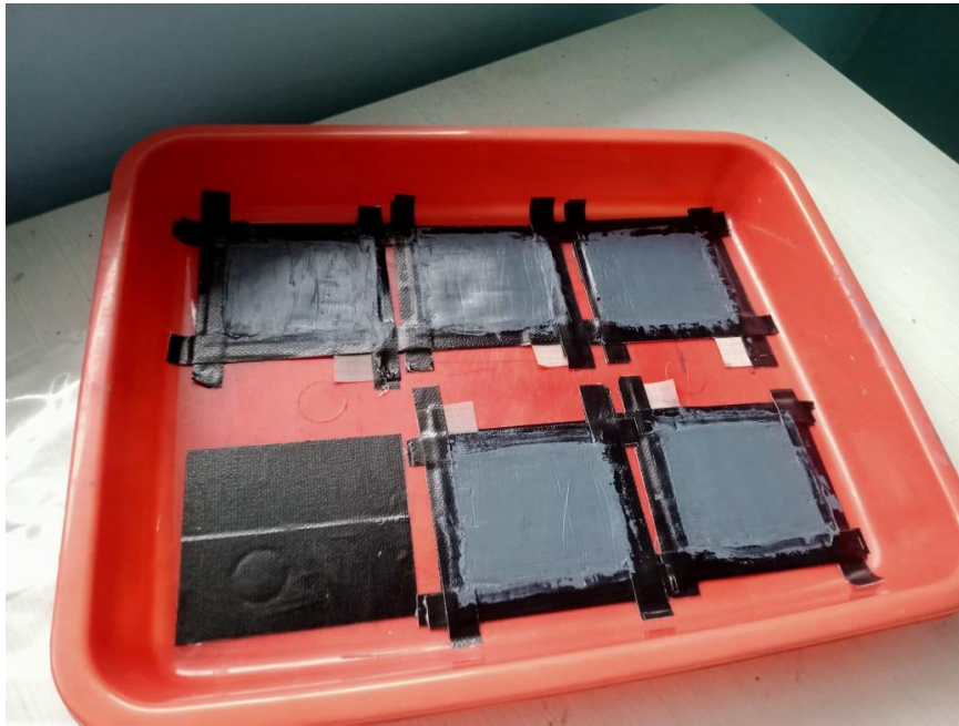
Gambar 3.11 Elektroda baterai yang telah di coating
