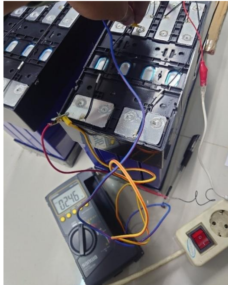
Gambar 2. 5 Kondisi Overdischarge Baterai
