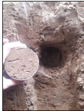
Pengambilan Sampel Tanah Lapisan Atas pada Lahan Aluvial
