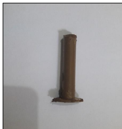
Pembuatan Pasta Tanah untuk Uji Kembang Kerut
