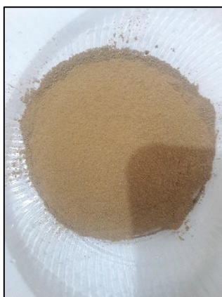
Tanah Lolos Saring 0,5 mm dari Laboratorium
