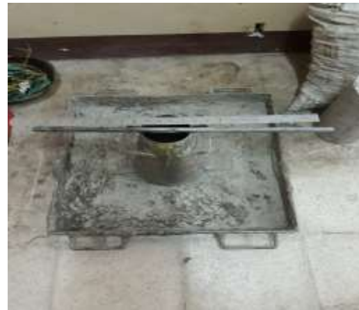
Gambar 3.14 Wadah Adukan Beton
