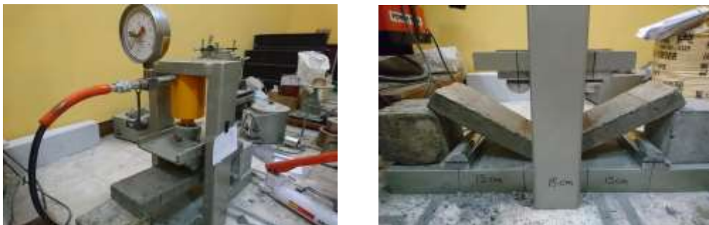
Gambar 3.26 Pengujian Kuat Lentur Beton
