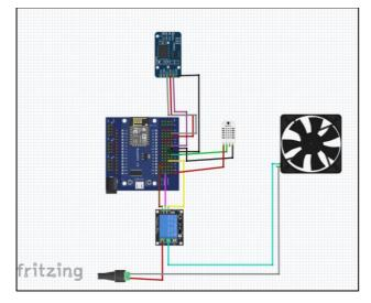
Fig. 9 Hardware Schema
