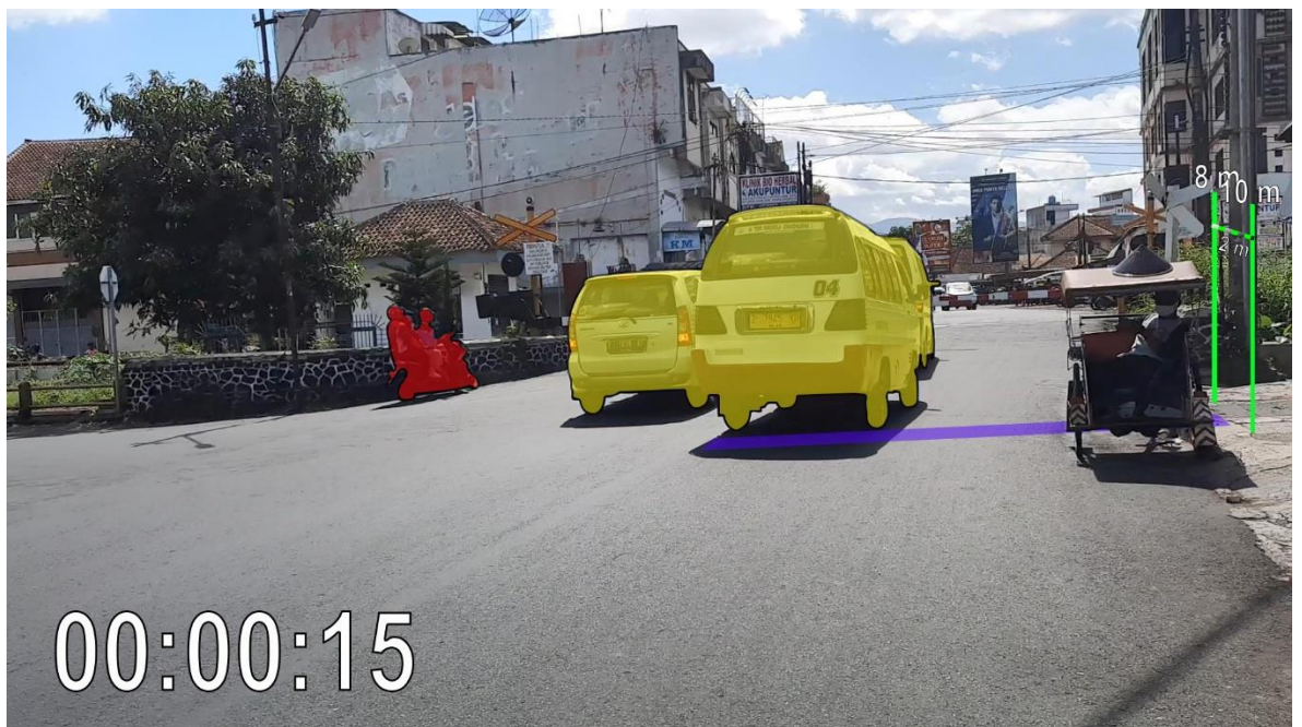
Gambar 3.8. Detik ke-15, kendaraan berhenti membentuk antrian sepanjang 9m.
