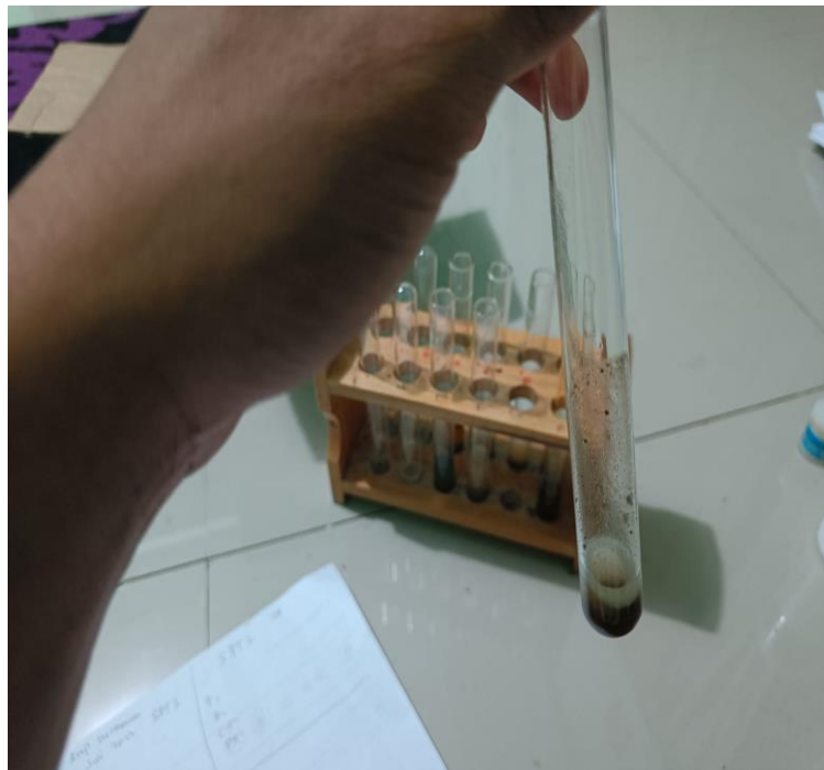
Lampiran 11. Hasil uji PUTK (perangkat uji tanah kering)
