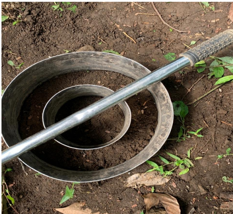
Lampiran 9. Pengukuran infiltrasi
