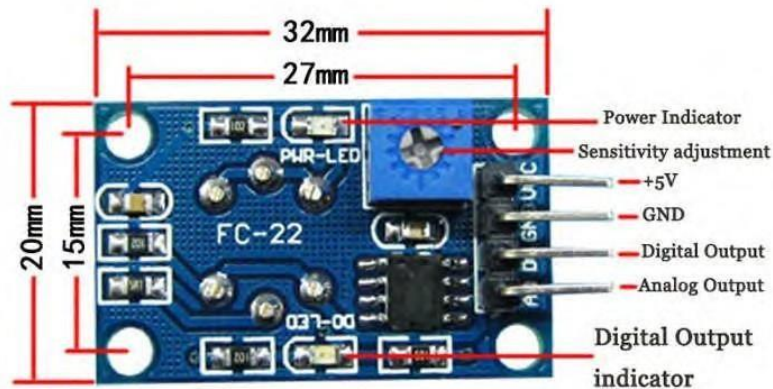
Gambar 2. 4Ukuran dan Bagian – Bagian Sensor MQ135
