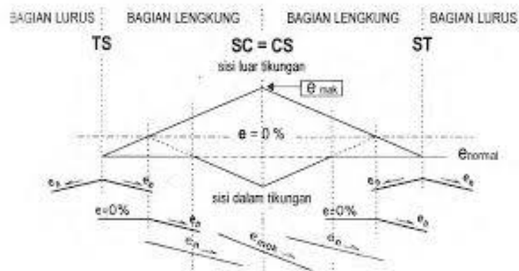
Gambar 2. 17 Diagram Superelevasi pada Tikungan SS
