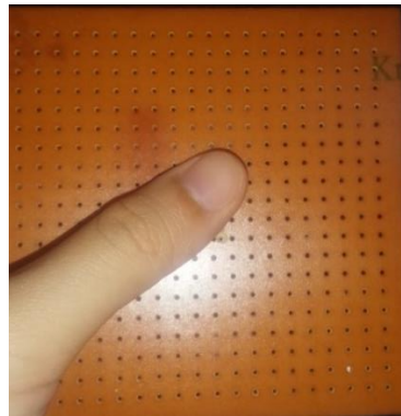
Gambar 2. 7 PCB Bolong IC
