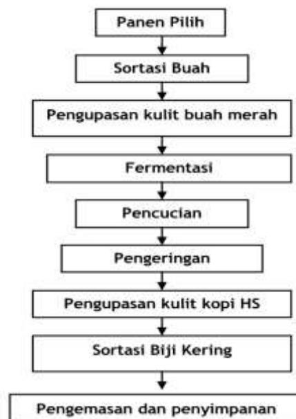
Gambar 5. Tahap Proses Kopi Secara Basah (*Fully Washed*)
