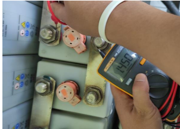
Gambar 3. 8 Hasil pengukuran tegangan
