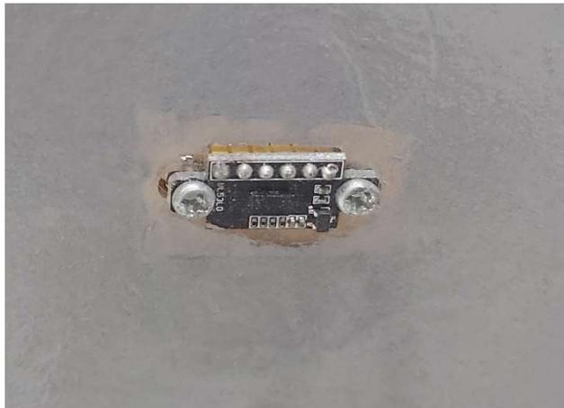
Gambar 4 Pemasangan Sensor VL53L0X.
