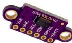
Gambar 2.14 Pin pada sensor VL53L0X (Maria and Susianti 2019)
