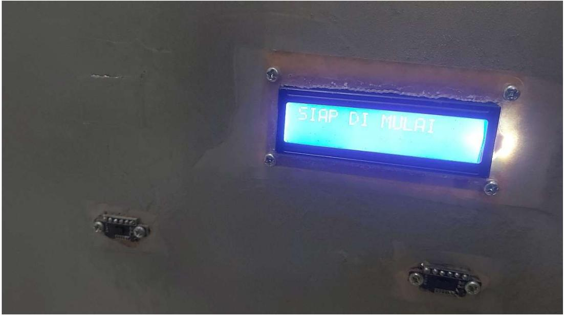
Gambar 3 Percobaan LCD I2C pada Alat VDGS
