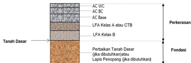
Gambar 2. 9 Perkerasan Lentur pada Permukaan Tanah Asli
