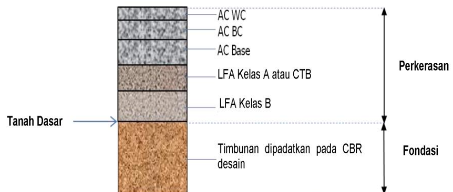
Gambar 2. 9 Perkerasan Lentur pada Timbunan
