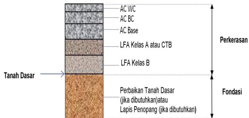
Gambar 2. 8 Perkerasan Lentur pada Permukaan Tanah Asli
