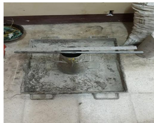
Gambar 3.14 Wadah Adukan Beton
