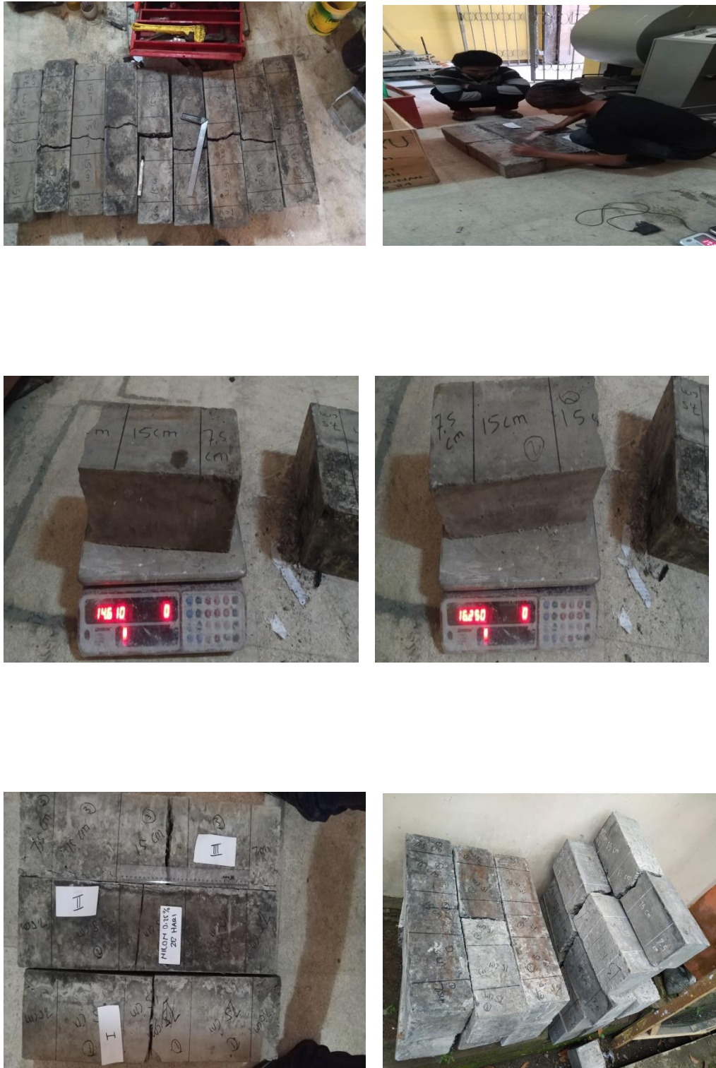
Gambar 3.34 Pengujian Kuat Lentur Beton
