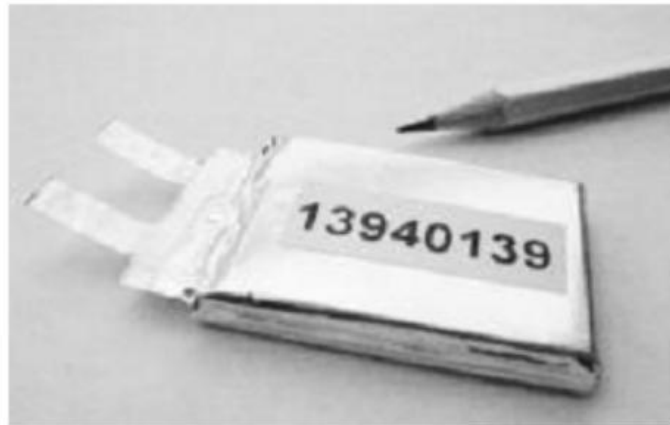
Gambar 2.8 Baterai kantung yang simpel, fleksibel dan ringan. Kapasitas listriknya dibawah baterai konvensional lain, disamping itu biaya produksinya terbilang mahal (Triwibowo, 2011)
