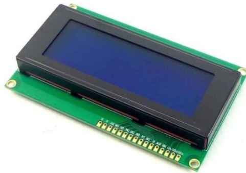
Gambar 2.19 LCD dengan 20x4 character
