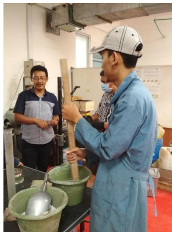
Gambar 3.18 Pengujian Pelapukan Agregat dengan Magnesium Sulfat
