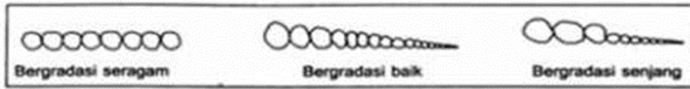
Gambar 1-2 Gradasi Agregat
